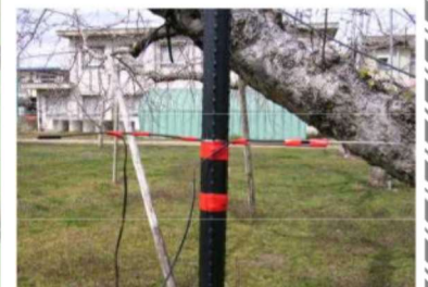
図2 温度センサーの設置方法
