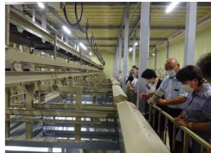
南相馬市小高区に完成した施設は、連続強制通風貯蔵乾燥方式の50ト角形貯蔵ビン50基備え、約400ha(水稻377.4ha、2359ト、大豆78ha、117ト)の処理が可能です。
